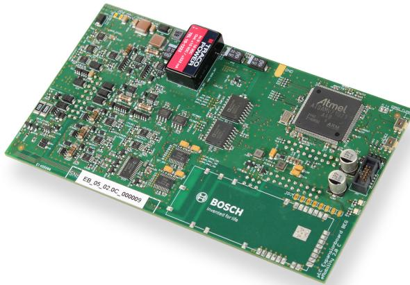
Die Erweiterungskarte E-Mobility ergänzt die Funktionen des μLC Test Systems um typische Sensorsignale aus dem E-Mobility-Bereich. Hierzu gehören Resolver-Signale, Strangstrom-Signale, Inkrementalgeber-Signale sowie ein 30 V-DAC. Alle Aus- und Eingänge sind kurzschlussicher gegen Masse und Versorgungsspannung.
